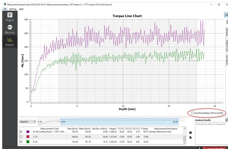
Die Funktions-Schaltfläche unterhalb des Drehmoment-Diagramm (Torque Line Chart) ermöglicht den schnellen Wechsel zwischen ungeglätteten Rohdaten und geglätteten Daten. Dies ist in den Modi „Messen“ sowie „Auswerten“ möglich.
