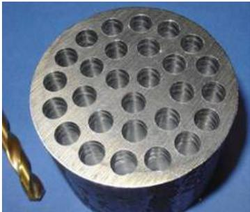
Bild 6: Prüfblock 16 Mn Cr5 / Bohrer
