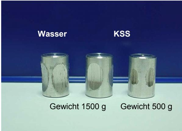
Bild 15: Verschleißmarken auf Al Mg Si<sub>0,5</sub>-Prüfkörpern
