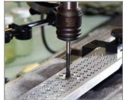
Der Micro Tap Tapping Torque Test (siehe Abbildung oben) ist in der metallbearbeitenden Branche als bewährtes **Bewertungsinstrument für Additive bekannt**. Entscheidend für dieses Programm war die Entwicklung von geeigneten Prüfprotokollen für jede bewertete Legierung. Magnesium, Aluminium, Edelstahl und Titan stellen jeweils völlig unterschiedliche Anforderungen.
