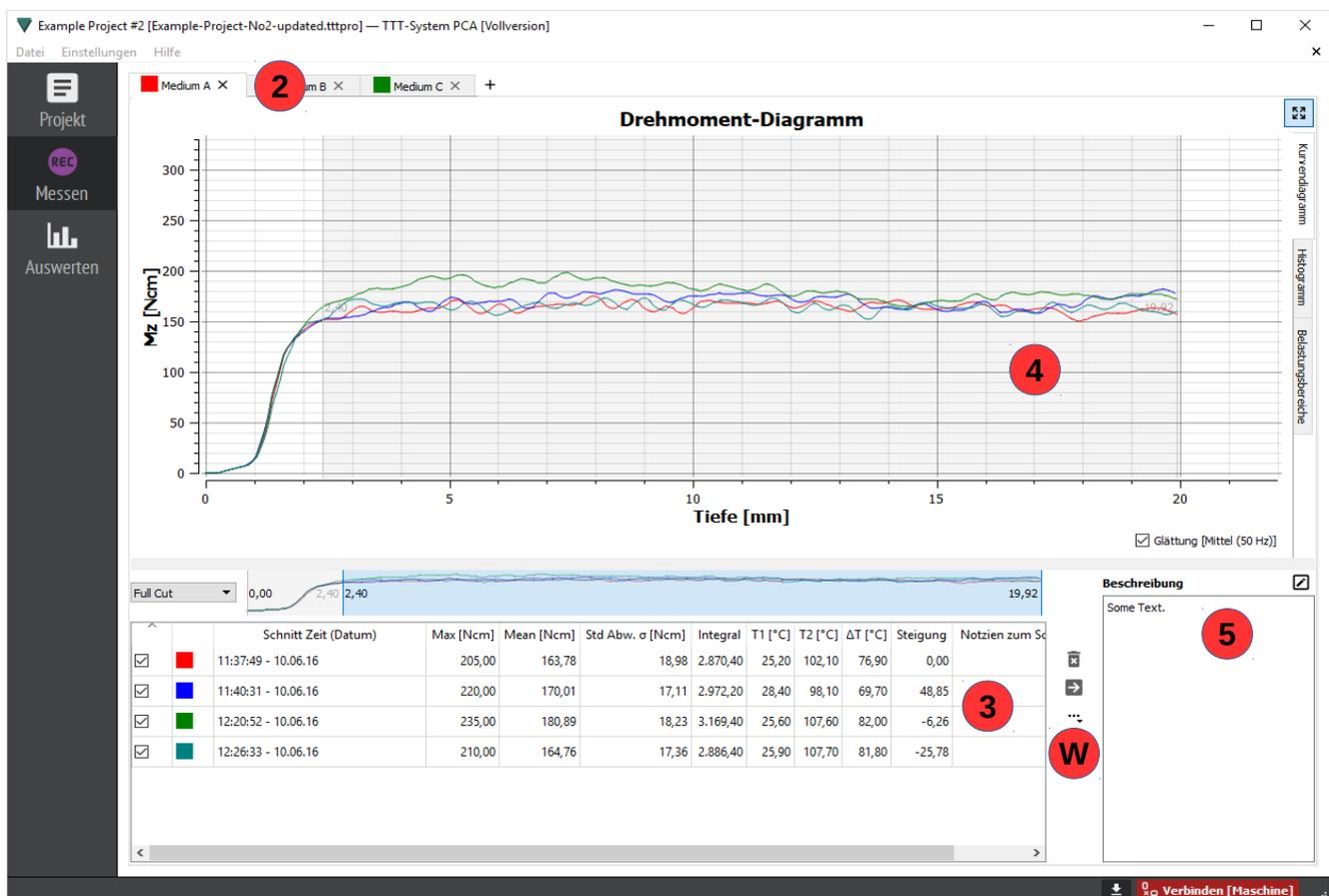
Die Tabelle [3] zeigt alle Messwerte die auch im Graphen [4] visualisiert sind. Unter Beschreibung [5] lässt sich ein Text zur Messreihe verfassen, dieser wird im Report (Drucken/PDF) angezeigt. Die Werte Max (= Maximales Drehmoment), Mean (Durchschnittliches Drehmoment) und Std. Abw. (Standardabweichung: Durchschnittliche Abweichung vom Mittelwert) bilden die Basis der
